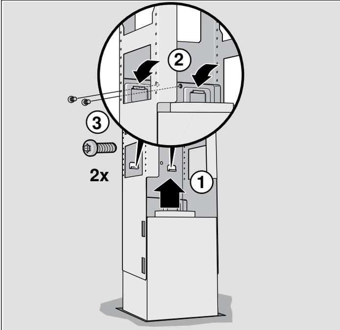
3. Sicherungsbügel einhängen und festschrauben.
