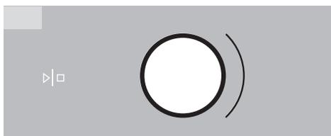
**1** Drehen Sie den EINSTELLKNEBEL (-/+ ) und stellen Sie zuerst die Minuten ein, darauf springt die Anzeige auf Stunden. Nach 3 Sekunden wird die Einstellung gespeichert.
