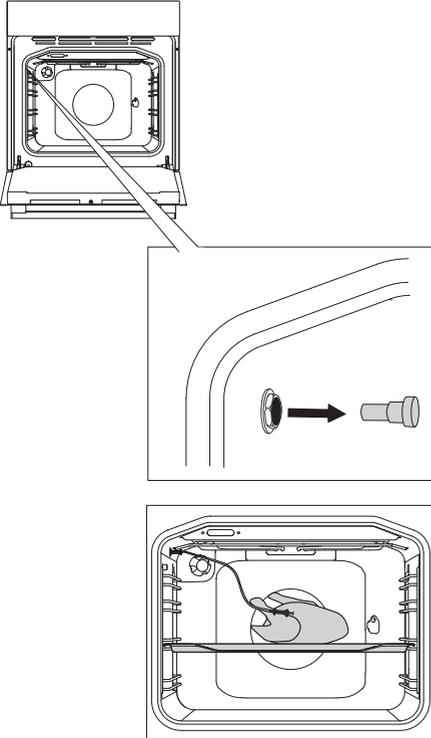
**1** Entfernen Sie den Metallzapfen (die Steckdose befindet sich in der vorderen rechten Ecke des Garraums).
