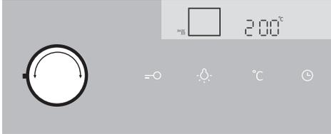
Drehen Sie den WAHLKNEBEL FÜR DIE BEHEIZUNGSART und wählen Sie SCHNELLES VORHEIZEN aus. Auf dem Display wird die VOREINGESTELLTE TEMPERATUR angezeigt, die Sie ändern können.
