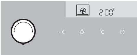
**1** Wählen Sie die BEHEIZUNGSART aus. Auf dem Display wird das ausgewählte Symbol angezeigt und die VOREINGESTELLTE TEMPERATUR blinkt.
