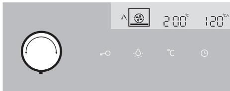
**3** Drehen Sie den WAHLKNEBEL FÜR DIE BEHEIZUNGSART und stellen Sie die gewünschte Betriebsart (Heißluft und Unterhitze) ein. Auf dem Display werden das entsprechende Symbol, die voreingestellte Temperatur und die Temperaturanzeige der Sonde angezeigt. Drücken Sie die START-Taste.
