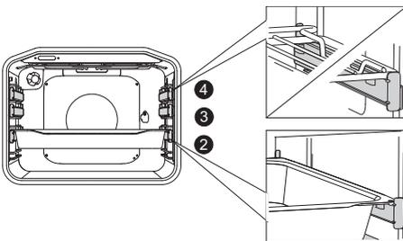
Ziehen Sie bei Teleskop-Ausziehführungen zuerst die Führung einer Einschubebene heraus und stellen Sie den Rost oder das Backblech darauf, schieben Sie danach die Führungen bis zum Einschlag ein.
