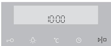
**2** Bestätigen Sie die Einstellung durch Drücken der Taste START/STOPP. Wenn sie innerhalb der nächsten drei Sekunden keine einzige Taste berühren, wird die Einstellung automatisch gespeichert.
