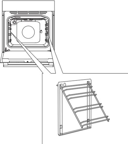
Entfernen Sie die Draht- bzw. Ausziehführungen.
