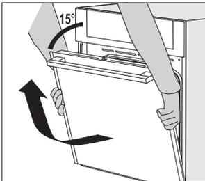
**1** Öffnen Sie zuerst die Backofentür bis zum Anschlag.
