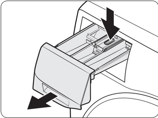
1. Ziehen Sie die Waschmittelschublade heraus, während Sie gleichzeitig den **Entriegelungshebel** in der Schublade herunterdrücken.
