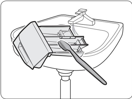
2. Reinigen Sie die Komponenten der Waschmittelschublade unter fließendem Wasser mit einer weichen Bürste.
