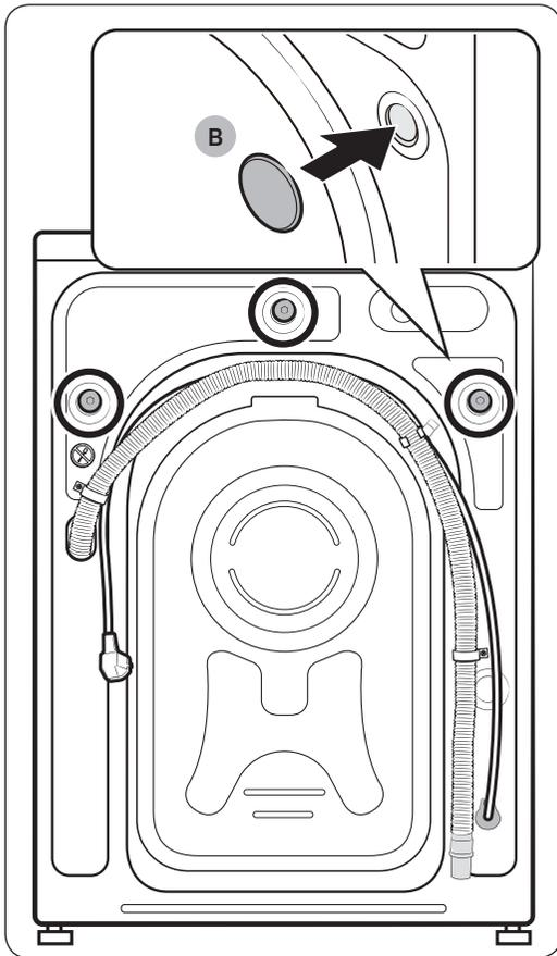
3. Setzen Sie die **Abdeckkappen (B)** in die Öffnungen ein (in der Abbildung mit einem Kreis markiert).
