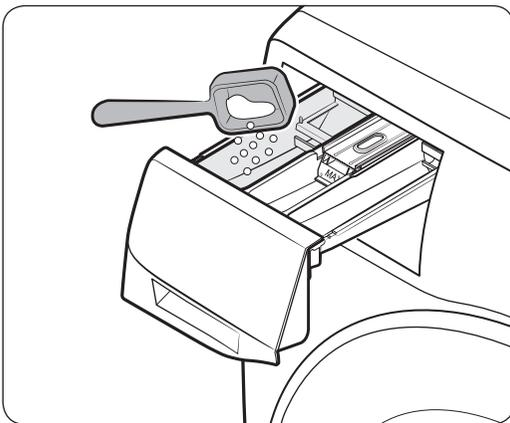
1. Ziehen Sie die Waschmittelschublade zum Öffnen heraus.
