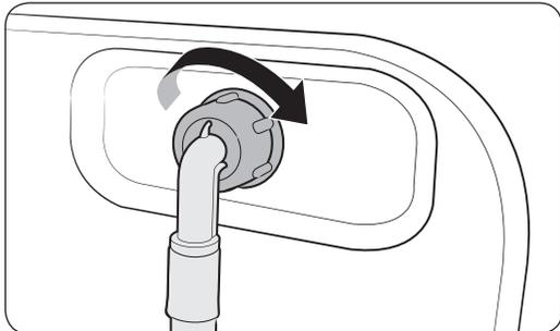
2. Schließen Sie das andere Ende des Frischwasserschlauchs an das Wassereinflussventil auf der Rückseite der Waschmaschine an und drehen Sie den Überwurfring dann nach rechts fest.
