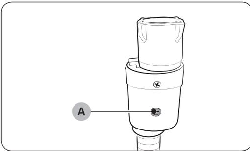
Der AquaStop-Schlauch warnt den Benutzer vor der Gefahr eines Wasseraustritts. Er misst den Wasserdurchfluss, und im Falle eines Lecks wechselt die **Anzeige (A)** in der Mitte des AquaStop-Schlauchs ihre Farbe zu rot.
