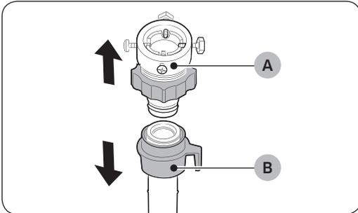
1. Entfernen Sie den **Adapter (A)** vom **Frishwasserschlauch (B)**.
