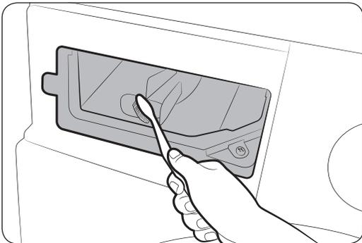
3. Reinigen Sie auch die Aussparung für die Waschmittelschublade mit einer weichen Bürste.
