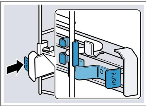
2. **PUSH** gedrückt halten ① und die Schiene nach außen schwenken ②.
