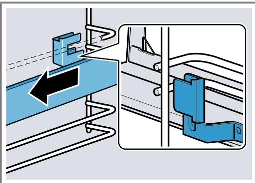
4. Die Auszugsschiene entfernen.
