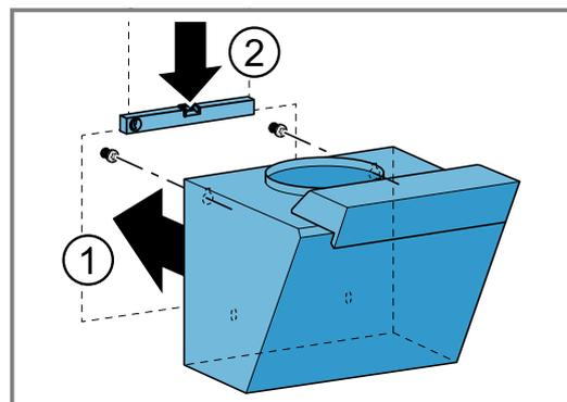
12. Die Bohrung für die Sicherungsschraube anzeichnen.
