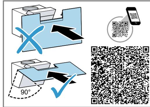
2. Die Halterungen der Filterabdeckung in die Öffnungen am Gerät einsetzen und einrasten.
