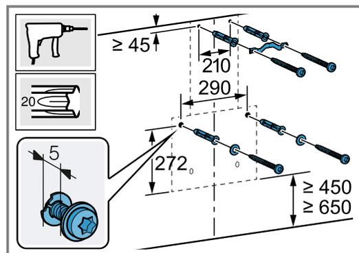
11. Das Gerät aufhängen ① und ausrichten ②.
