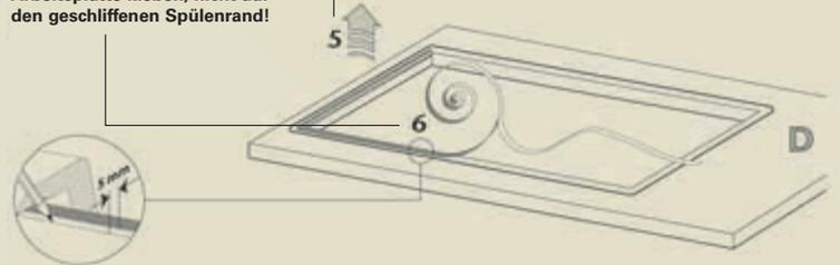
Außenkontur-Markierung der Spüle auf der Arbeitsplatte entfernen, Spülenrand reinigen.
