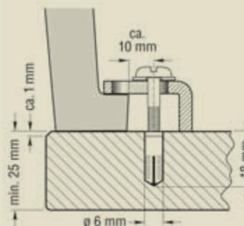
Bei den Ausschnittmaßen sind die keramischen Toleranzen und ein Sicherheitsabstand mit berücksichtigt. Daher kann in verschiedenen Fällen die Abdeckplatte bis zu 11 mm (7 mm bei 6705) über den Beckenrand ragen.
