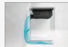
Installation mit Luftaustritt rückseitig „BACK OUTLET“ Installation "BACK OUTLET"
